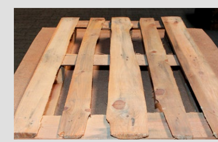
Componente não conforme que não está de acordo com os Regulamentos Técnicos da EPAL, por exemplo, subdimensionado, podre
