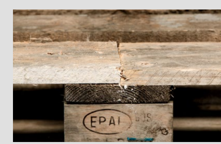
Reparação não conforme
